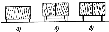
Рис. 36. Изделия корпусной мебели, устанавливаемые на опорных коробках (а), скамейках (б), подсадных ножках (в)
